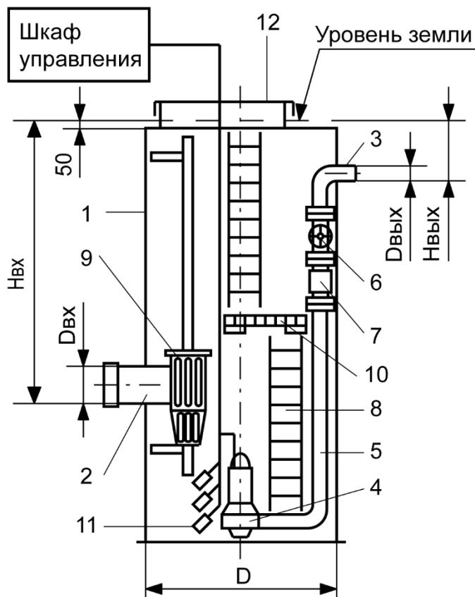
Рисунок 1 - Схема канализационной насосной станции
